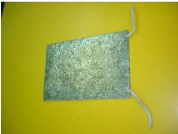
Fig. 6.8 Element încălzitor cu fir CrNi în zigzag dispus între plăci de mică
